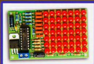
Автомат световых эффектов на микроконтроллере.
