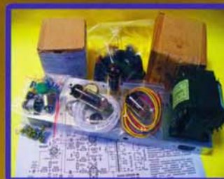
Двухтактный оконечный усилитель на 6Н23П и 6П43П.
