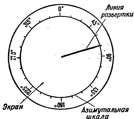
Рис. 36. Азимутальная шкала трубки с радиально-круговой разверткой
