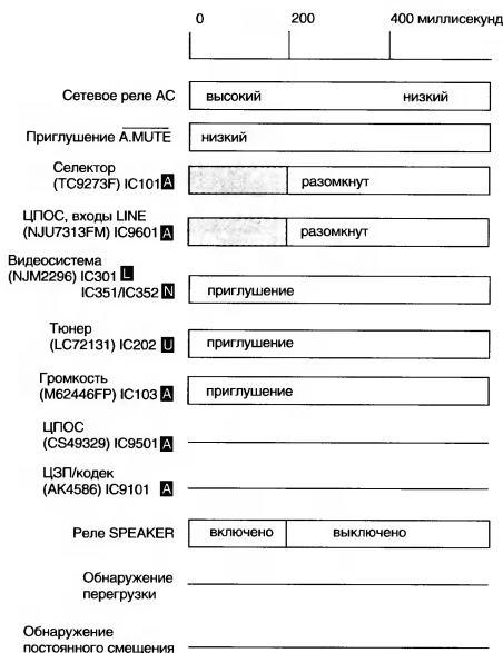
Рис. 28. Временная диаграмма выключения ресивера
