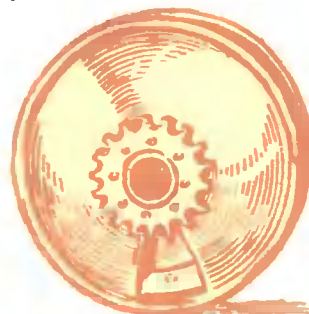
Рис. 5. Обод с тормозным барабаном в сборе: 1 — тормозной барабан, 2 — диск колеса, 3 — место для подшипника № 201, 4 — звездочка на 18 зубьев, 5 — штифт \varnothing 6 мм.
