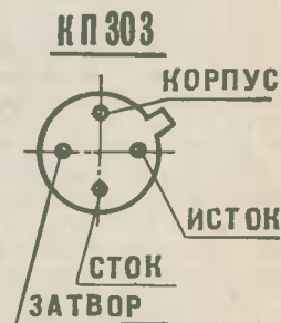
Рис. 2. Расположение выводов транзистора.
