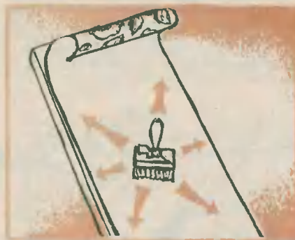
Рис. 16. Клей наносим щеткой или большой кистью — от середины к краям.
