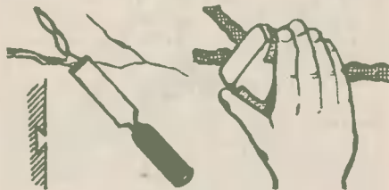
Рис. 8. Устранение трещин на потолке: разделка шпателем, шпаклевка и после сушки зачистка шкуркой.
