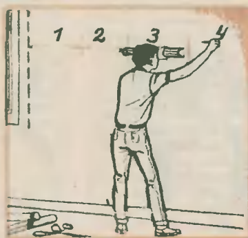
Рис. 11. Устранение дефектов стены (стрелкой показаны движения руки): 1 — разделка трещины шпателем, 2 — зачистка пылесосом, 3 — смачивание водой, 4 — приготовление шпаклевки, 5 — заделка трещины шпаклевкой, 6 — оклейка марлей, 7 — окончательная зачистка шкуркой после просушки.
