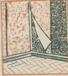
Рис. 22. Угол лучше проходить стыком двух полотнищ (или половинками одного из них).
