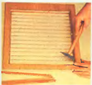
5 В фальцы рамы крышки вставляют решетку, которую фиксируют штапиками на гвоздях.
