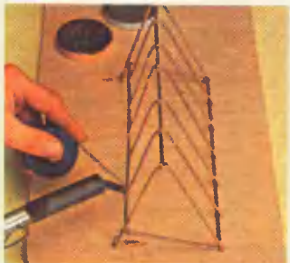
3 Кормушку, как и решетку крышки, делают из проволоки толщиной 3 мм. Детали соединяют пайкой.
