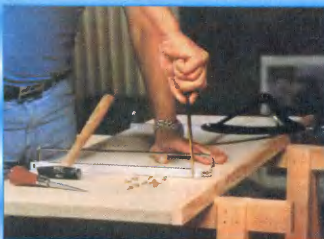
12 Выдвижные скалки привинчивают к полкам. Довольно мощный брус служит усилением, предотвращающим прогиб доски.
