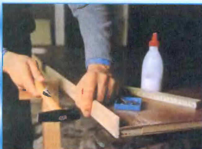
10 К боковой кромке двери крепят ручку-планку так, чтобы сзади она была заподлицо с дверным полотном, а спереди выступала вперед. Способ крепления — клей и гвозди.
