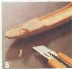
5. В палубе вдоль бортов резачком делают канавки для последующего крепления нитей.
