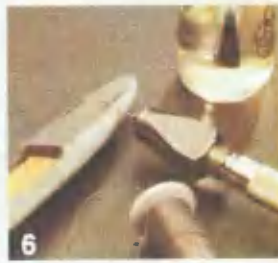
6. Тонким сверлом \varnothing 0,3-0,5 мм в бортах модели (в местах канавок) делают отверстия для крепления нитей.
