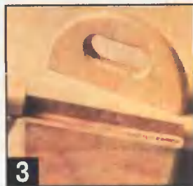
Изготовление и установка ручки подноса: 1 — сверление отверстий; 2 — закругление кромок с по- мощью фрезы; 3 — контрольная примерка подноса перед закреплением ручки.
