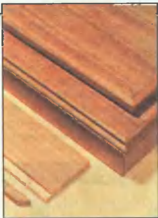
1. Детали тумбы шкафа: крышка и дно (с приклеенным цоколем высотой 139 мм). Рядом — заготовка цоколя с выбранным фальцем. Если к ней приклеить раскладку, образуется фальц с другим профилем.
