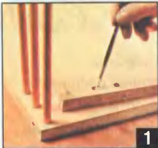
Сборка столика: 1 — установка на клею декоративных стоек; 2 — закрепление боковины.
