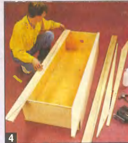
4 Детали каждой ножки серванта вырезают из двух сосновых досок толщиной 15 мм по рисунку и собирают на шурупах. Перед креплением ножек к корпусу проверяют их параллельность боковым стенкам.
