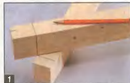
1 Размеченные по длине в соответствии с рис. 4 заготовки брусков треугольных скатов крыши раскладывают на ровной площадке концами друг на друга так, чтобы они образовали треугольную раму. Места их взаимного перекрытия отмечают карандашом.
