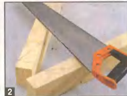
2 Одна из диагоналей ромба, полученного в результате разметки, и будет линией резания при запиливании «на ус».
