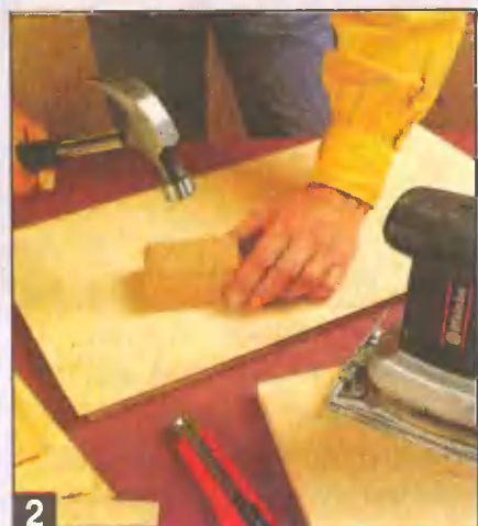
2 Чтобы при наклеивании шпона на основу не образовывалось пузырей, фанеруемую поверхность пристукивают через пробковую прокладку и приглаживают горячим утюгом. Лишние кромки шпона обрезают острым ножом.
