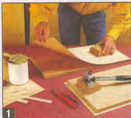
1 Изготовление серванта начинают с фанерования выкроенных деталей.
