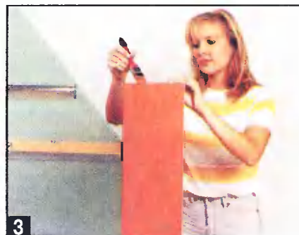
3 Внешние видимые кромки полок, вырезанных из ДСП, шпаклюют и шлифуют особенно тщательно. Иначе внутренние слои ДСП на торцах будут впитывать значительно больше краски, чем гладкие поверхности полок.
