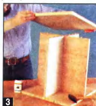
3 Соединение же полок и перегородок с боковыми стенками модуля выполняют на клею и шкантах.
