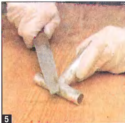
5 После отверждения клея шов (так же, как и сварочный или паяный) обрабатывают напильником.
