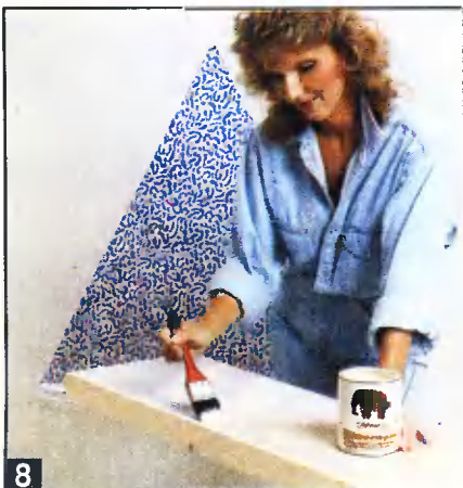
8 Отшлифованную и зашпаклеванную поверхность полок сначала грунтуют, чтобы обеспечить хорошее сцепление лакокрасочного покрытия с древесиной.
