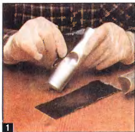
1 контактирующие поверхности деталей тщательно обезжиривают и обрабатывают шлифовальной шкуркой.
