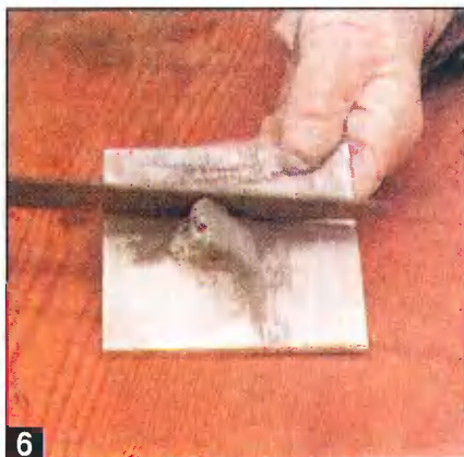
6 Из смеси металлического порошка или опилок с клеем можно сформировать недостающую часть детали или пробку, заполнить ею полость.
