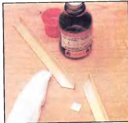
После зачистки поверхность промывают одним из рекомендованных очищающих средств. Это может быть ацетон, спирт, очищенный бензин.
