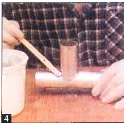
4 Из выступившего из стыка труб клея формируют шпателем равномерный шов, обеспечивающий прочное и герметичное соединение.
