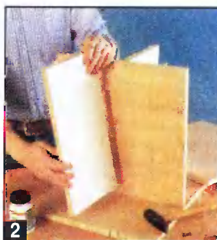
2 Вертикальные перегородки базового модуля из облицованной пленкой ДСП приклеивают к центральной несъемной полке встык без шкантов.
