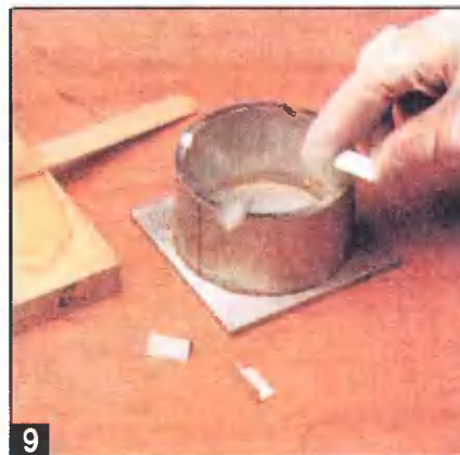
9 Жидкий клей наносят тонким слоем при склеивании небольших деталей. Для получения шва на стыках деталей клей наносят толстым слоем.
