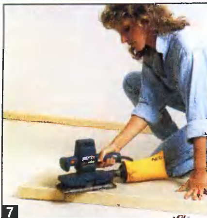
7 Виброшлифовальная машинка позволяет быстро выровнять переход между наклеенными кромочными рейками и плоскостью полок.
