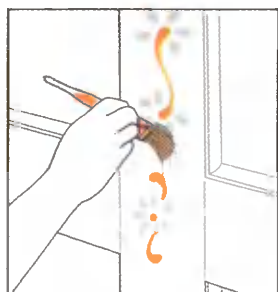
Узоры, нанесенные на подверженные интенсивному износу деревянные поверхности, покрывают защитным прозрачным лаком.
