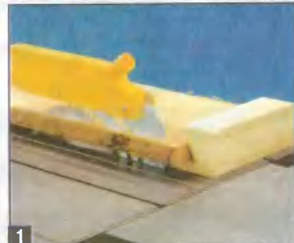
1 При обрезке досок на настольной дисковой пиле с направляющим пазом желательнее пользоваться самодельным противовыбрасывателем (см. рис. 1).
