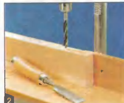
2 Пазы для шиповых соединений выбирают электродрелью, закрепленной на сверльной стойке. Сверлят ряд отверстий Ø10 мм и затем удаляют стамеской промежутки между ними.
