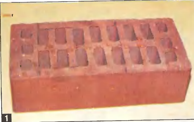
На фото 1–3 показаны строительные материалы — керамический кирпич, бетон и газобетон после обработки гидрофобизатором АКВАСТОП-К.
