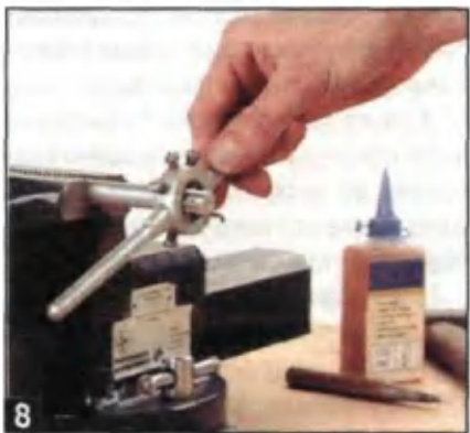
При нарезании резьбы плашкой стержень необходимо смазать машинным маслом на всей длине, где необходимо нарезать резьбу.
