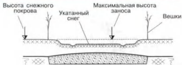
Рис.2. Высота заносов на укатанной дороге значительно меньше, чем при традиционной расчистке.
