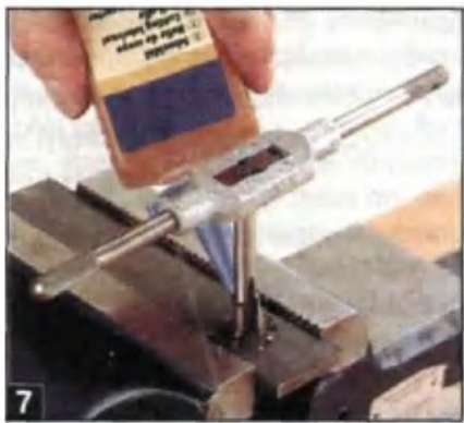
Смазка не только снижает трение и вероятность поломки инструмента, но и позволяет получить более чистую резьбу без «подрывов» и «замятий».
