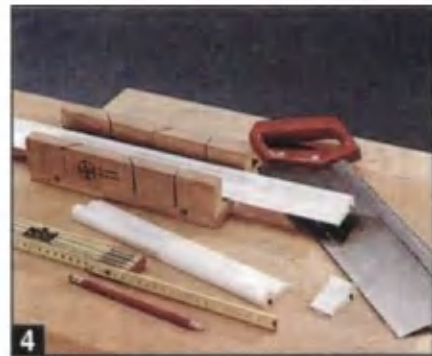
Галтель раскраивают по длине с помощью мелкозубой пилы и стусла, распиливая ее строго под прямым углом.
