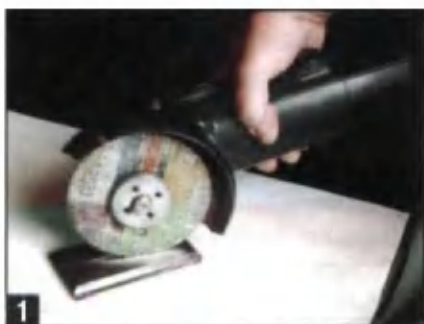
1 Пропиливание канавок под ракушки.
