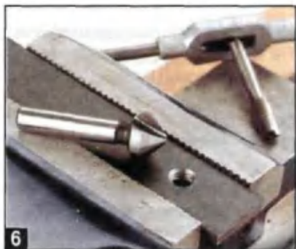
Чтобы облегчить заход метчика, нужно обязательно раззенковать кромки отверстия.
