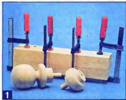
Заготовки для точеных фигурных деталей склеены из двух брусков.
