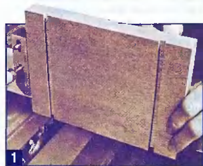
В заголовке каждой «книги» пропиливают пазы шириной 6 мм для вставок.
