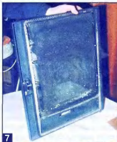
7 Готовая к установке дверца печи в сборе с термостойким стеклом и защитной металлической сеткой.
