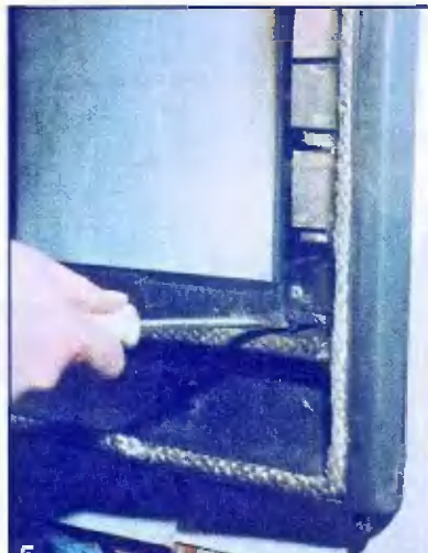
5 Установка термостойкого стекла при помощи зажимных планок.
