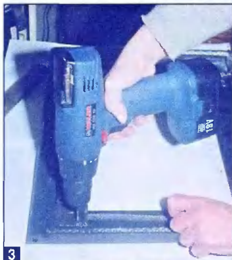
3 Сверление отверстий для крепления уголков к дверце печи.
