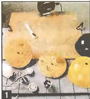
Деталь в виде яичницы-«глазуньи» и две шайбы вырезают электролобзиком.
