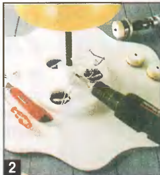
Три отверстия под лампы вырезают кольцевой пилой. В отверстия встраивают лампы.
