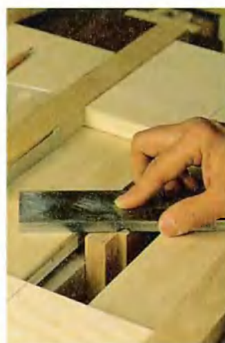
Обрабатываемую деталь крепят заподлицо с крышкой столика, контролируя положение металлической линейкой.
