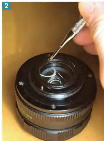
2 Перевернув объектив тыльной стороной, начинаем его разборку.
