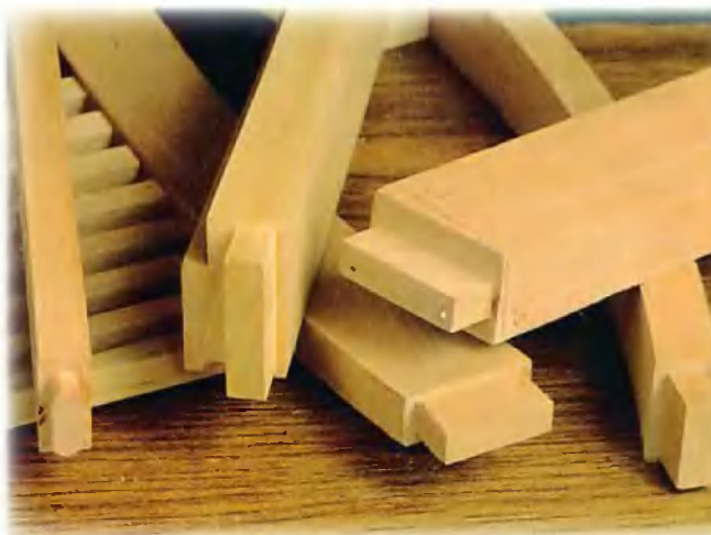
Разметка шипа на пробной детали, которая должна быть такой же толщины и ширины, как реальная.
