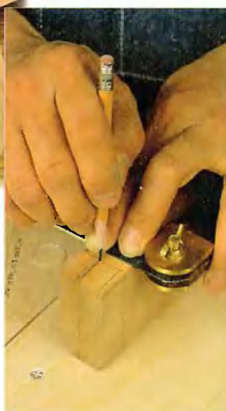
Разметка шипа на пробной детали, которая должна быть такой же толщины и ширины, как реальная.
