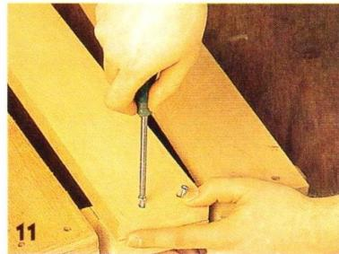
вильности положения связи, сверлят в ней крепёжные отверстия — по два для каждой детали спинки (**фото 11**). Временно скрепив детали спинки с поперечной связью, намечают внешний контур последней. Закруглённые торцы поперечной связи должны совмещаться заподлицо с наружными кромками крайних деталей спинки. Отсоединяют поперечную связь от деталей спинки и придают ей требуемую форму электролобзиком. Кромки распилов шлифуют, после чего поперечную связь прикрепляют к спинке.
