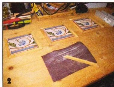
Запиленные «на ус» детали рамок подогнал друг к другу, подправляя угловые соединения шлифовальной шкуркой.
