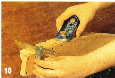
равномерный скос под углом 85° (**фото 10**). Контролируют углы настроенной малкой.
