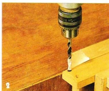
**2** Поставив опорные элементы подставки на ровную поверхность, сверлят в них отверстия и соединяют болтами обе детали. Раскроив по длине поперечные планки, одну из них скругляют со стороны пласти. Сняв фаски на рёбрах планок, укладывают планки рядом друг с другом и в 12 мм от торцов сверлят по два отверстия под шурупы: сначала — глухие сверлом Ø8 мм по дереву на глубину 5 мм (фото 2) — под заглушки, затем — сквозные сверлом Ø4 мм — под шурупы.
