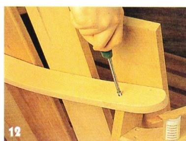
подгоняют по ширине к поперечной связи. Нижние торцы подпорок закругляют, а верхние — запиливают на скос так, чтобы подогнать их к поперечной связи и тыльной стороне крайних деталей спинки. Разметив детали, состругивают лишнее. Сверху подготовленную подпорку соединяют с поперечной связью шурупами (**фото 12**), а снизу — с боковой царгой на болтах с гайками.
