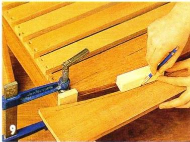
ной 25 мм намечают углубления в тыльной планке под детали спинки (**фото 9**). Углубления вырезают электролобзиком.
