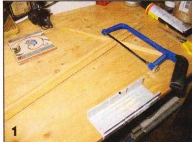
Выполнив разметку на планках, нарезал элементы для рамок в самодельном стусле. В качестве шаблона для разметки использовал плитку-декор.
