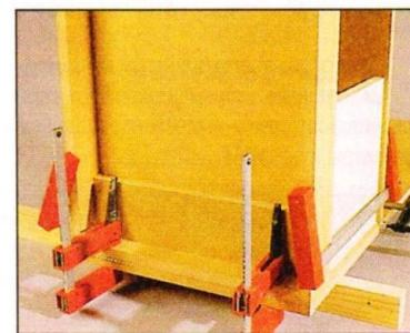
**4** Наметив положение верхнего ящика, на контактирующие поверхности наносят клей, устанавливают ящик на место и временно стягивают подборки струбцинами. Здесь важно обратить внимание на то, чтобы кромки деталей были совмещены заподлицо друг с другом.
