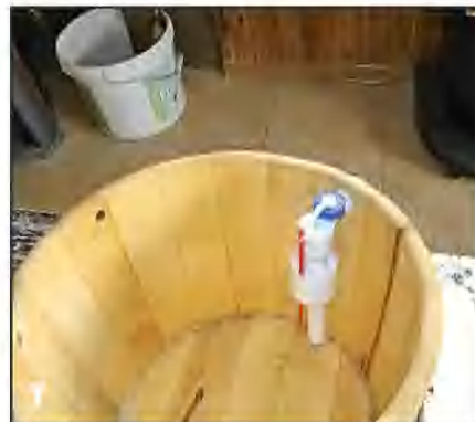
В обливное ведро установил поплавковый клапан.
