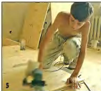
После подгонки деталей ящики разбирались, и их поверхности тщательно шлифовались.
