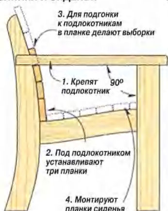
Рис. 5. ПОДГОНКА ПЛАНОК СПИНКИ И СИДЕНЬЯ
