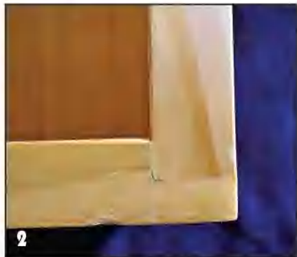
2 Для угловых соединений в боковых стенках ящиков выбирал четверти. Соединял детали мебельными стяжками.
