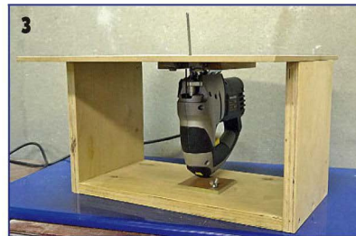
3 Благодаря направляющим лобзик легко снимать и устанавливать. Под лобзиком закрепил пластиковую пластину-опору.
