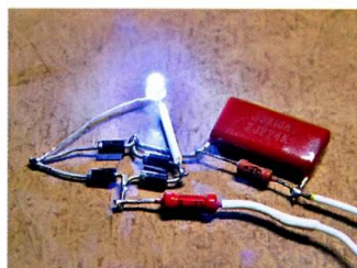
Спаянная навесным монтажом простейшая схема питания одиночного светодиода от сети.
