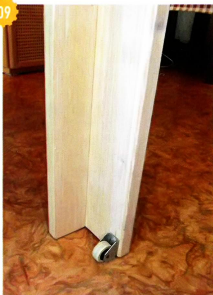
09 Ножки выкатной секции поставлены на ролики. Зазор между полом и ножкой — 2,5 мм.
