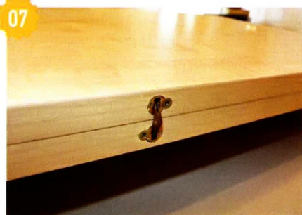
07 Две половинки столешницы соединены тремя ломберными петлями.
