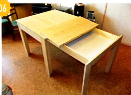
06 Столешница выкатной секции состоит из двух половинок 850 × 400 мм. Под столешницей — плоский ящик для хранения столовых приборов.
