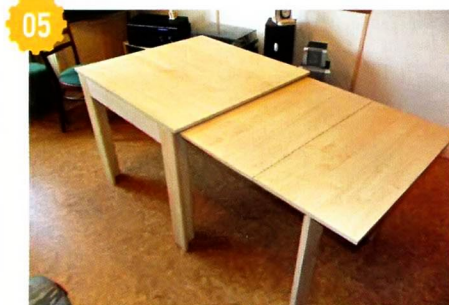
05 Столешница выкатной секции стола на царге не закреплена. При необходимости её можно выдвигать или задвигать на 150 мм.
