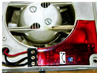
Пластиковая прозрачная крышка закрывает плату с электронным реле времени.
