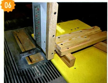
**06** Далее закрепил вертикальный упор, на кромку которого установил дубовый ограничитель. Окончательно фиксировать упор лучше прямо на станке. Так легче точно выставить вертикали во всех плоскостях. Крепил всё на саморезы, для защиты пильного диска отверстия под них глубоко отзенковал.
