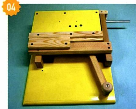
**04** От колебаний платформы вокруг металлического стержня установил ограничители в виде брусков с выбранной четвертью, а на конец рычага добавил ручку.
