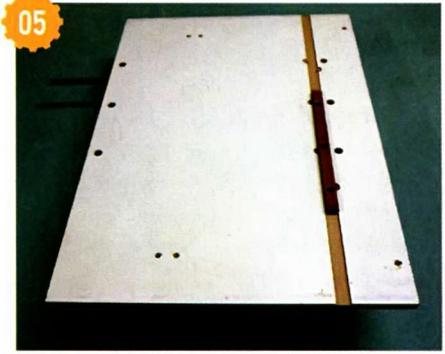
**05** Перед установкой приспособления на станок на нижнюю поверхность основания установил направляющую (на фото основание перевернуто). Её положение зависит от максимального вылета подвижной платформы (рычаг максимально вправо) — она в этом положении должна почти касаться пильного диска, не доходя на толщину вертикального упора. В моём случае — 16 мм.
