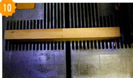
**10** Теперь остаётся выпилить древесину из заготовки в интервале между зафиксированными ограничителями. Если паз — широкий, его можно выбрать за несколько проходов, посте-
