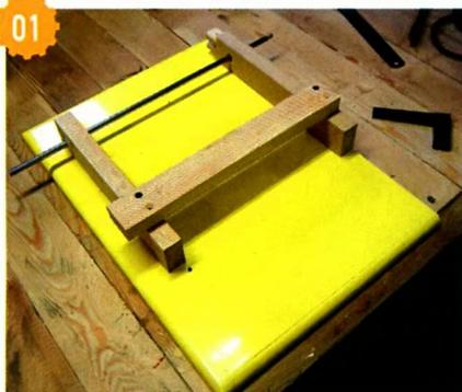
нуля — положения, когда диск касается вертикального упора. Кроме того, прикрепил крючок к ограничителю вертикального упора. Дело в том, что заготовка фиксируется к упору с помощью струбцины, и крючок призван защитить её от случайного падения на пильный диск во время работы из-за вибрации или плохой затяжки.
