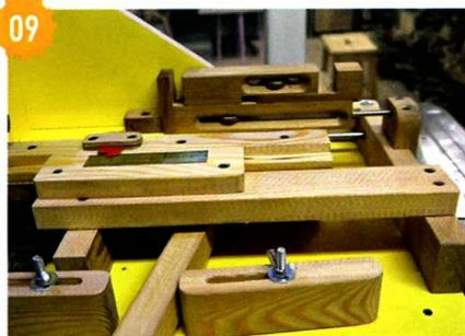
**09** Замеряю и фиксирую по линейке толщину шипа. Новое положение рычага фиксирую вторым ограничителем — это положение рычага и есть второй край паза.
