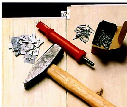
Инструменты и материалы для крепления панелей — молоток, магнитный добойник, стальные кляммеры и гвозди длиной 30 мм.
