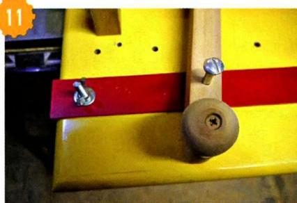
**11** В том месте, где будет располагаться кондуктор, закрепил полоску из мягкого ПВХ. И, контролируя положение диска по шкале, оставлял отметки стержня на пластике. Одновременно зажимал обрезок доски и делал запилы в местах, отмеченных на пластике. После этого снял пластик с отметками и пропиленную заготовку — и стал вычислять закономерность.
