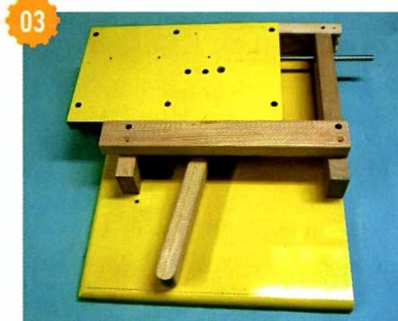
**03** После объединения двух частей платформа стала плавно перемещаться вдоль направляющей (стержня), поэтому я сразу расширил отверстия шарниров и установил постоянные оси — использовал винты с короткой резьбой, чтобы резьба не разбивала отверстия.
