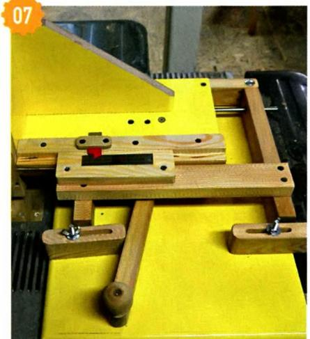
**07** С обратной стороны установил подпорку, регулируемые ограничители и шкалу с указателем. Шкалу и указатель сделал из металлической линейки. Указатель имеет возможность подстройки
