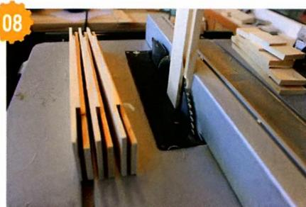
детали рамок. Пильный диск выставлю на 6 мм. Расстояние от упора до пилы — 50 мм.
