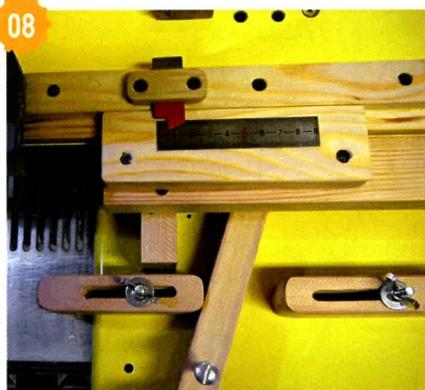
**08** Для изготовления ответной части замеряю и устанавливаю положение одной стенки паза заготовки по линейке и фиксирую его ограничителем.
