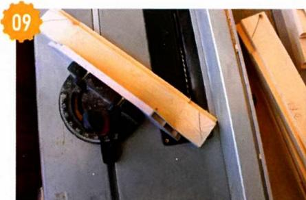
ку и поднимаю его до наружного края — на 60 мм. Расстояние от упора до пилы уменьшаю на 2,5 мм (на толщину диска).
