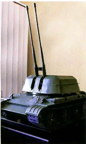
ЗСУ-57-2 (объект 500) — советская зенитная артиллерийская самоходная установка на легков бронированном гусеничном шасси, состояла на вооружении с 1955 года.
