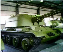
ЗСУ-57-2 (объект 500) — советская зенитная артиллерийская самоходная установка на легков бронированном гусеничном шасси, состояла на вооружении с 1955 года.
