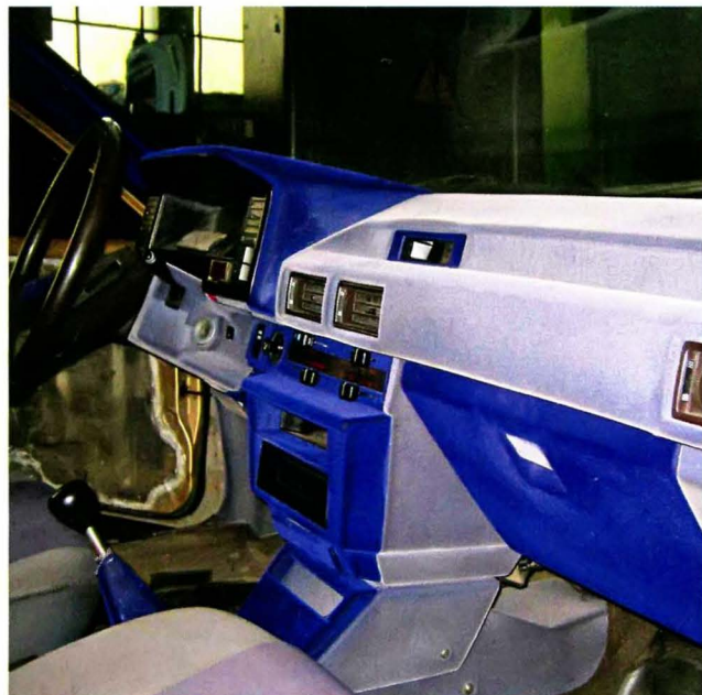
Флокирование также используют для обновления стайлинга салона автомобиля.
