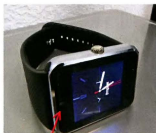
Камера находится над циферблатом. Размеры циферблата: длина — 48 мм, ширина — 41 мм, толщина — 12 мм.
