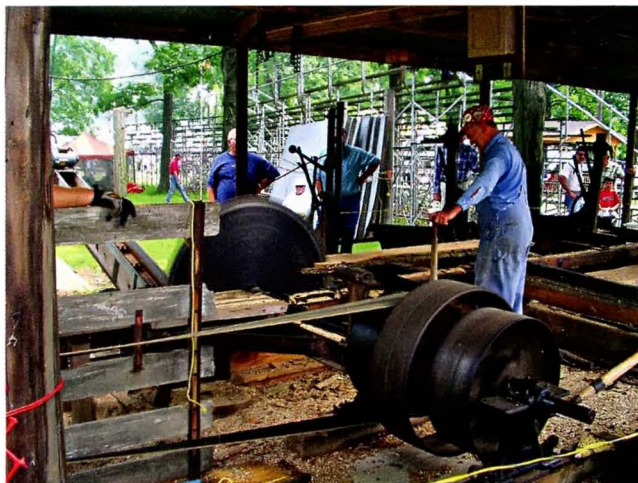
Паровые пилы работают посредством ременной передачи. Очень часто для работы паровых пил использовали паровые трактора и другие паровые механизмы.
