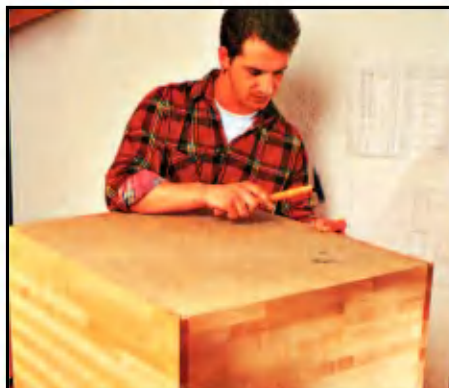
Заднюю стенку (оргалит) шкафа крепят к боковым стенкам мелкими гвоздями или скобками.
