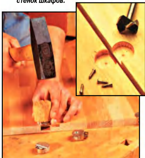
В местах соединения деталей шкафов друг с другом сверлят отверстия под мебельные стяжки.
