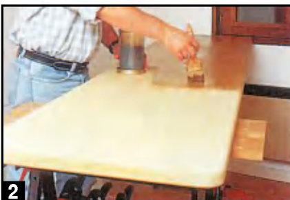
2 Отшлифовав кромки, цокольную плиту и полки покрывают в несколько слоев мебельным лаком. После наложения очередного слоя необходима промежуточная сушка и, при необходимости, подшлифовка.
