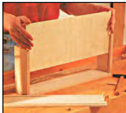
Днище (тонкая фанера) выдвижного ящика вставляют в пазы, выбранные в боковых стенках.
