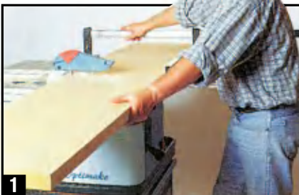
1 Раскрой древесностружечных плит начинают с наиболее длинной детали — панели цоколя. Полки и другие одинаковые детали целесообразно раскаивать, сложив несколько плит в стопку.
