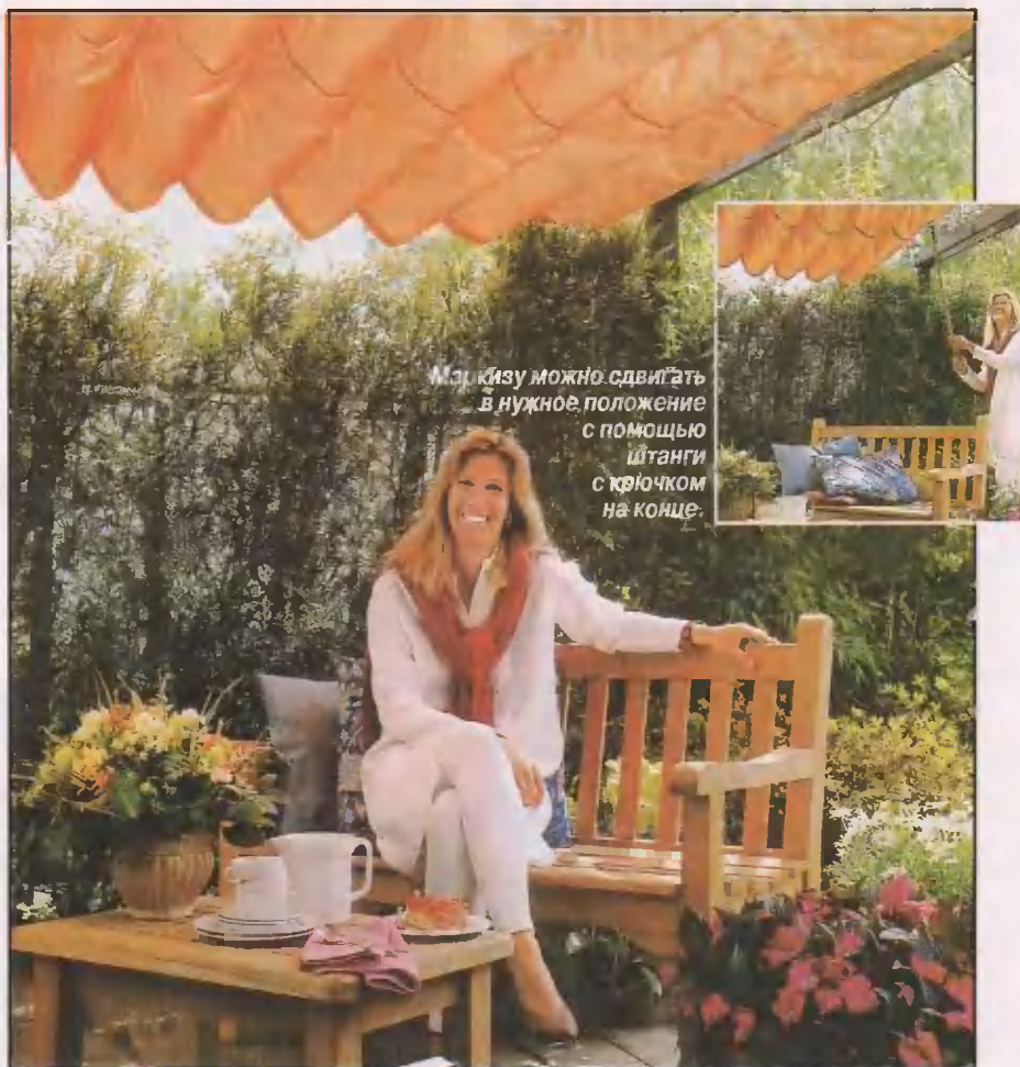
Рис. 3. Маркизу с четырьмя рядами колец подвешивают на двух тросах. Два талрепа обеспечивают необходимое натяжение тросов, благодаря чему маркиза почти не провисает.
