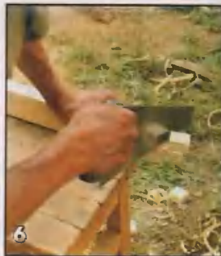
Шип в ответной детали вырезаем с помощью ноковки.
