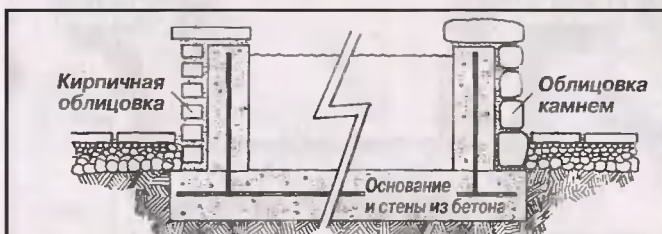
Рис. 6. Для возвышающихся над землей водоемов можно использовать бетон, залитый в опалубку. Поверхности стенок таких водоемов часто отделывают декоративными материалами. Стенки для повышения прочности следует армировать.
