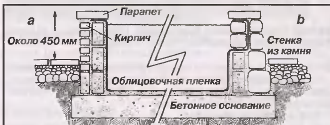
Рис. 5. Возвышающиеся над землей водоемы, построенные из бетонных блоков: а — водоем, облицованный кирпичом; б — водоем, облицованный камнем. В обоих случаях облицовку можно уложить так же, как в двух предыдущих примерах. Высота парапета — около 450 мм, что подходит для устройства сиденья.
