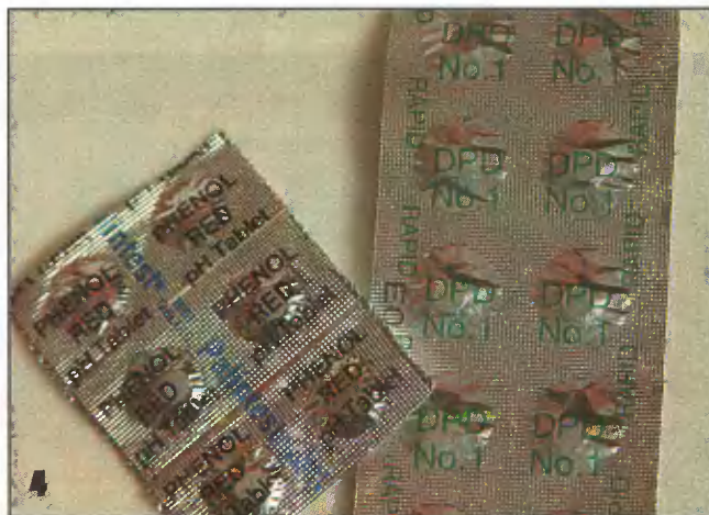
Таблетки «Phenol Red» для определения pH воды и таблетки «DPD №1» для определения содержания свободного хлора.
