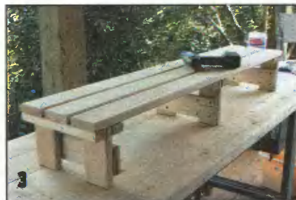
Приставная скамейка имеет простейшую конструкцию. Высота её — 200 мм.
