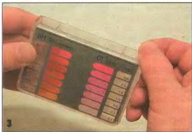
Сравнение цвета полученных растворов с контрольными шкалами на корпусе тестера «DPD-методом».
