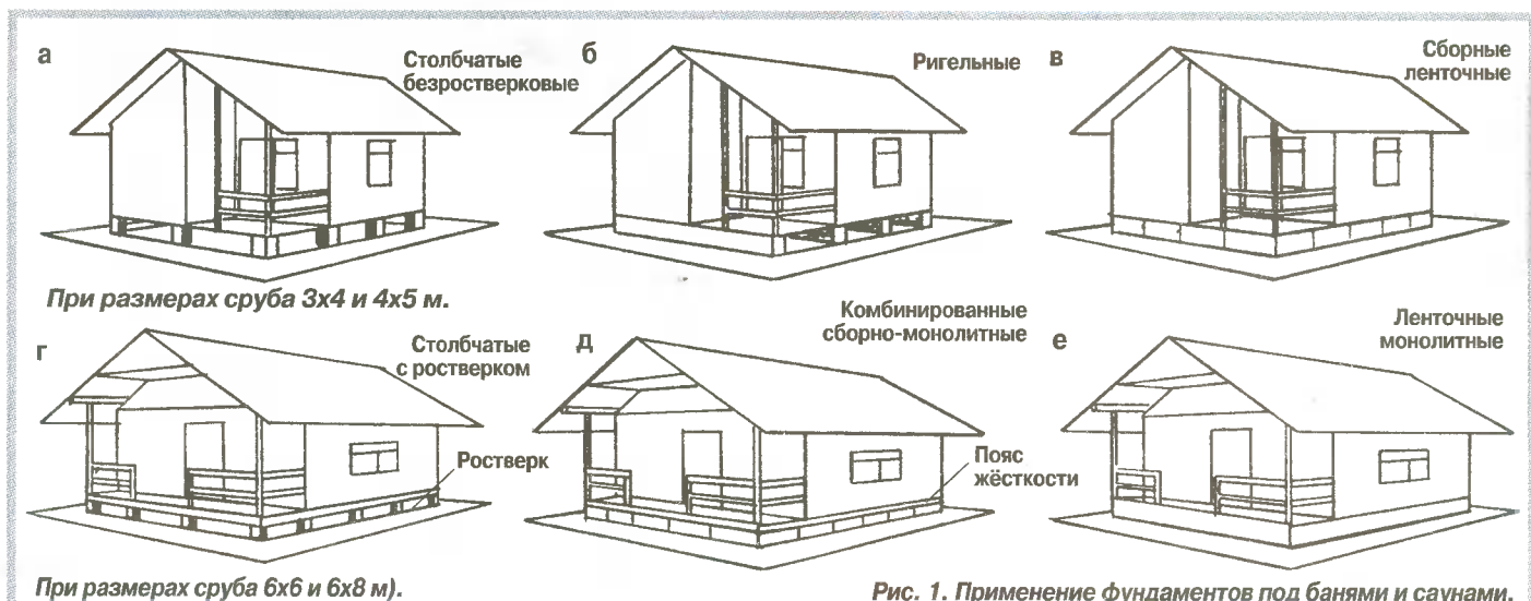
Рис. 1. Применение фундаментов под банями и саунами.
