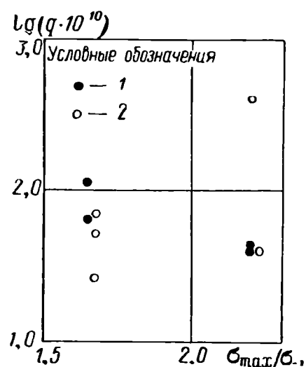
Рис. 3. Влияние максимального значения амплитуды напряжений \sigma_{\max} в двух-уровневых нестационарных испытаниях на удельное повреждение q_{\sigma_{\min}} . 1 — серии IV, V, \sigma_{\min} = 0,8\sigma_{-1} ; 2 — серии VI, VII, \sigma_{\min} = \sigma_{-1} .
