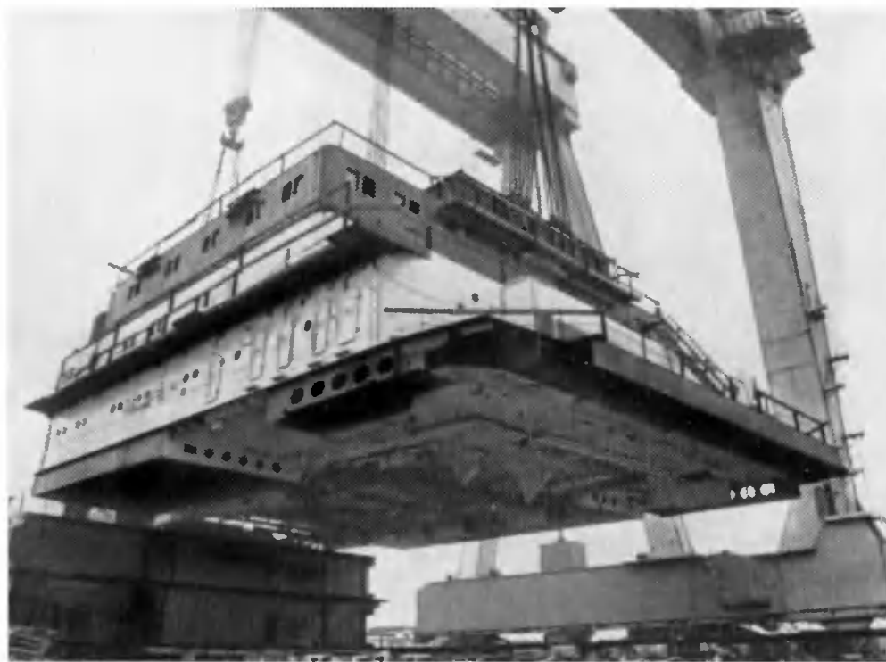
Перемещение блока надстройки при постройке нефтерудовоза «Борис Бутoma».
