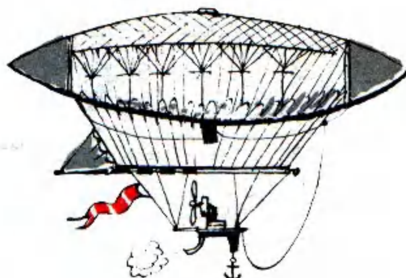
Аэростат французов, братьев Тиссандье. Его винт вращала паровая машина.
