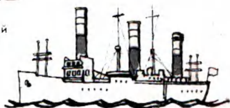
Исчезли парусные корабли. И вот в океане снова появилось судно, приводимое в движение ветром. Только вместо парусов у «Барбары» были громадные вращающиеся цилиндры.
