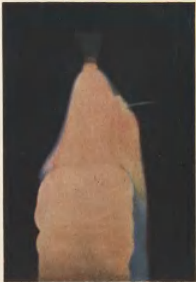
Рис. 34. Фотография процесса выращивания монокристалла вольфрама с применением плазменного нагрева
