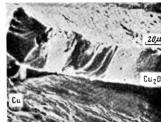
Рис. 52. Включения окиси меди в разрушенном медном образце. Сканирующая электронная микроскопия
