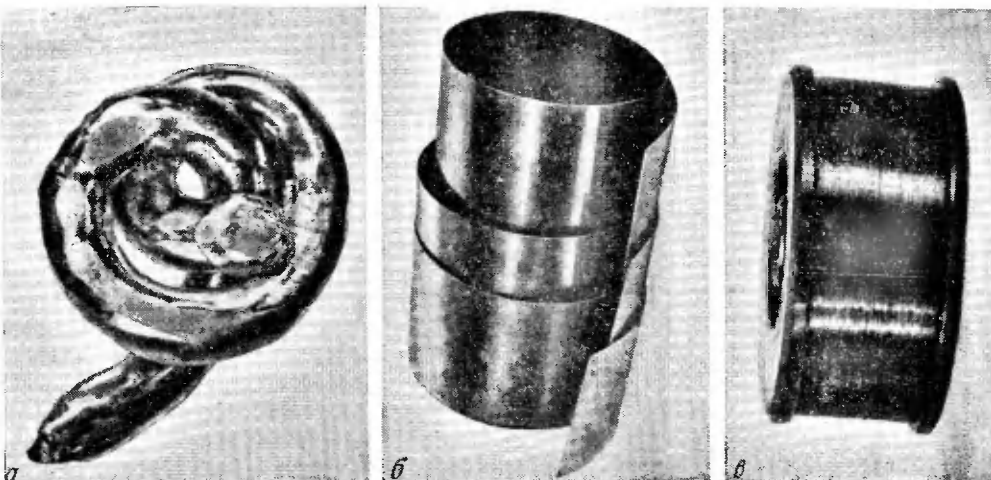
Рис. 85. Монокристалл молибдена, завязанный узлом (а), фольга (б) и проволока (в)
