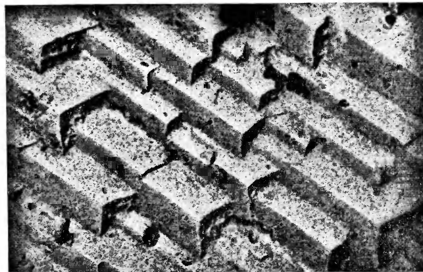
Рис. 18. Ступеньки роста на поверхности монокристалла вольфрама, \times 5000
