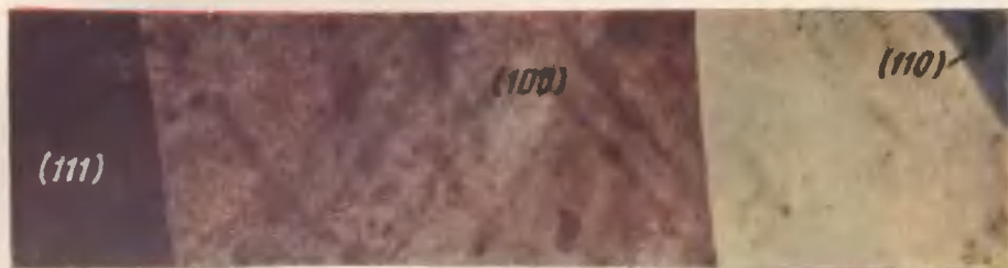
Рис. 37. Окраска зерен в зависимости от их кристаллографической ориентации
