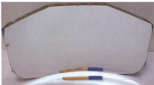
**Главное зеркало оптико-механического сканирующего устройства с конической разверткой МСУ-СК.**
