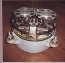
ЗУ ЗА025 на магнитной ленте шириной 12,5мм с подруливаемыми кассетами. Цифровая 16-ти дорожечная запись С1978г. по 1988г. использовалась на большинстве КА в системе ТМ систем.
