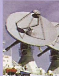
Корабельная параболоческая антенна диаметром 25м. Разработана по программе полётов на Луну, использовалась и в других программах.
