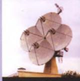
Антенна Б-520 «Ромашка». Со времени разработки в 1971 г она является основной антенной телеметрических систем, разрабатываемых предприятием отрасли. Зеркальная система состоит из четырех зеркал диаметра 6 м каждое.
