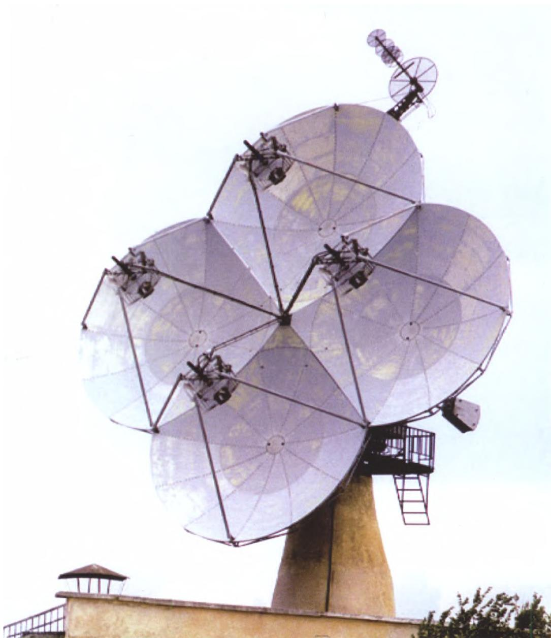
**Телеметрическая антенна Б-529 «Ромашка».**
