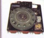
Э103 малогабаритное ЗУ на магнитной ленте 6,25мм. Конструкция кассеты над кассетой.
