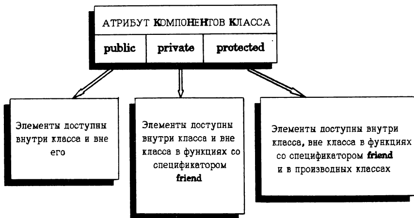
Рис. 3.1. Использование атрибутов private, public, protected для защиты доступа к компонентам класса
