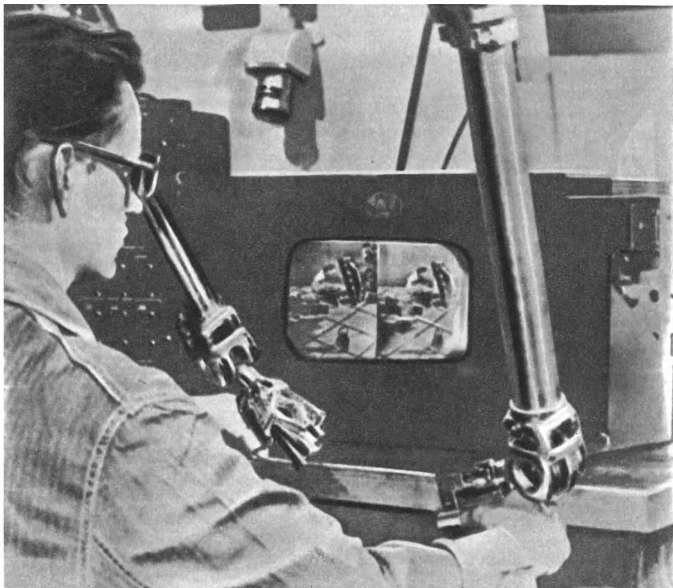
Оператор управляет дистанционным манипулятором с помощью стереоскопической телевизионной установки.
