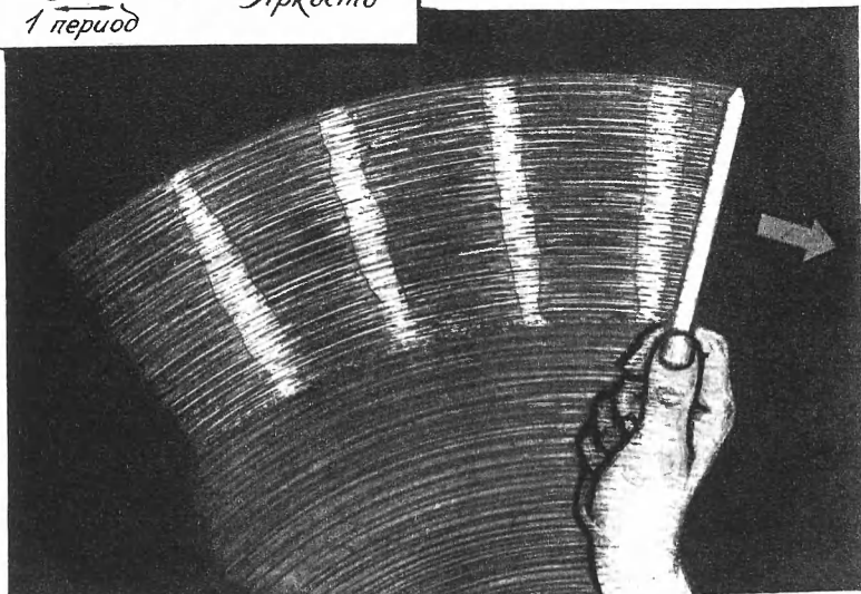
Движущийся тонкий блестящий стержень при мерцающем свете люминесцентной лампы. Вверху, слева,— графики изменения тока через лампу и изменения яркости света.
