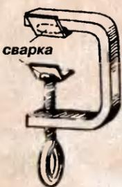
биться, приварив один уголок к винтовому зажиму, наложив второй уголок и затем прижав их вместе к верхней лапке скобы струбцины, как показано на рисунке. Теперь верхний уголок приваривается к скобе без всяких осложнений.
