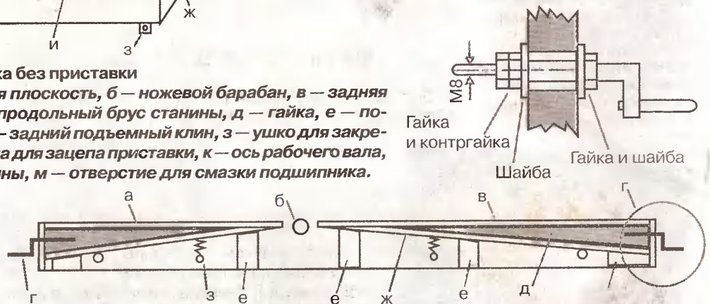
Рис. 3. Продольный разрез станка а — передняя подъемная плоскость, б — ножевой барабан, в — задняя подъемная плоскость, г — ручка подъемного устройства, д — подъемный клин, е — поперечный брус, ж — наклонная доска для передвижения клина, з — пружина.
