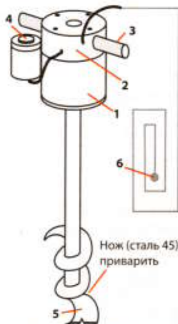
Рис. Расположение деталей 1 — стартер, 2 — хомут, 3 — ручки, 4 — кнопка пуска, 5 — ножи (Ст. 45), 6 — клеммы на аккумуляторе
