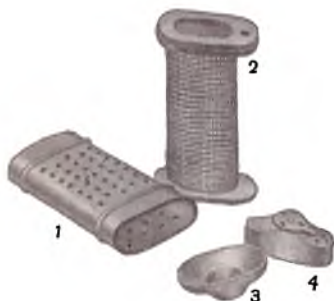
Рис. 2. Грелка химическая угольная типа JTA-1 (в разобранном виде): 1 — корпус грелки с отверстиями; 2 — сетчатый карнас, внутри которого находится угольный стержень; 3 — боковая крышка глухая; 4 — боковая крышка с отверстиями
