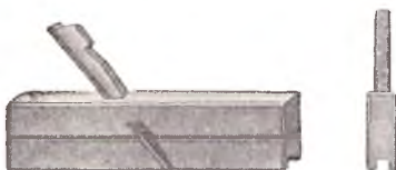
Рис. 2. Шпунтгельб для обработки гребней (федерхельб)
