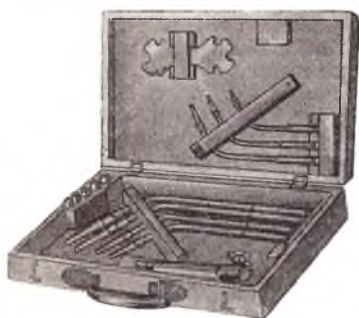
Горелка сварочная ГС-53 со сменными мундштуками и принадлежностями в деревянном чемодане
