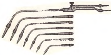
Горелка сварочная ГС-53 с комплектом сменных мундштуков
