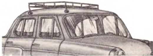
Багажник металлический, установленный на автомобиле «Москвич»
