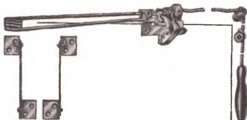
Рис. 3. Фрамужный прибор штампованный пружинный
