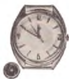
Рис. 1. Часы электрические наручные (батарейные) — слева часовая батарейка
