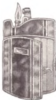
Рис. 6. Бензо-искровая зажигалка, сблокированная с портсигаром
