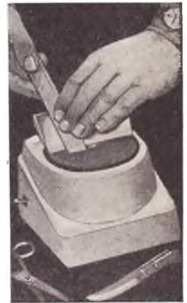
Рис. 1. Электроточилка бытовая с горизонтально расположенным шлифовальным кругом
