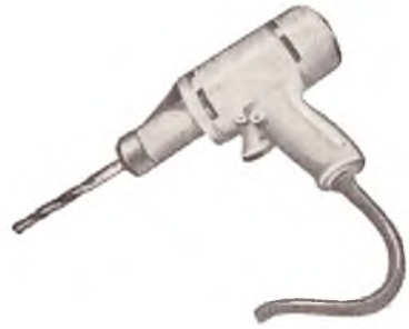
Рис. 2. Электросверлилка по металлу типа И-90
