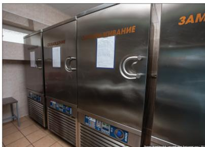
Рисунок Б.9 – Быстрое охлаждение питания в специальном холодильнике
