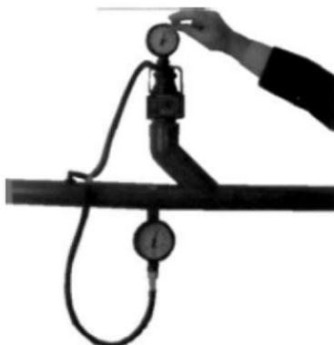
**Рисунок 2.16 – Регулировка вакуумметра**
