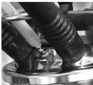
*Рисунок 2.29 – Проверка отверстия для впуска воздуха*
