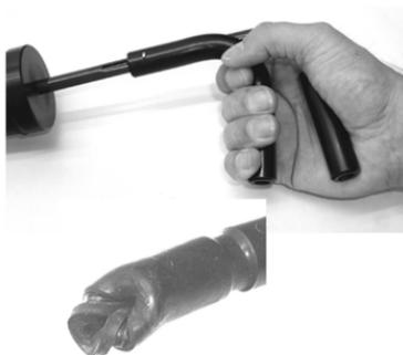
***Рисунок 6.16 – Стягивание сосковой резины***
