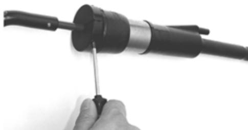
*Рисунок 6.14 – Затягивание зажимного винта*
