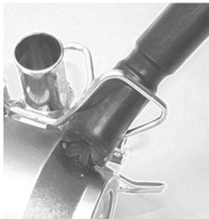
***Рисунок 6.25 – Установка сосковой резины в коллектор***
