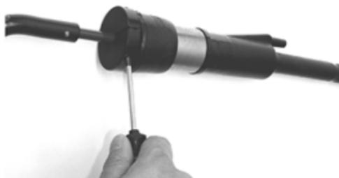
*Рисунок 6.14 – Затягивание зажимного винта*
