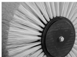
Удалите нижнюю пластину и старый цилиндр щетки. Установите щетку на ось. Установите нижнюю пластину и болт на место.
