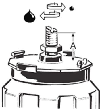
**Рисунок 1.5 – Грубая регулировка подачи масла**
