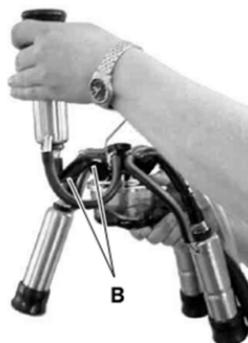
***Рисунок 2.26 – Надевание доильных стаканов***
