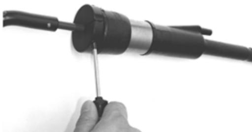
***Рисунок 6.22 – Затягивание зажимного винта***
