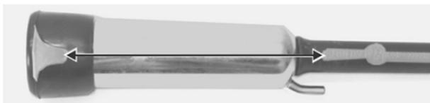
**Рисунок 6.20 – Метки на доильном стакане**
