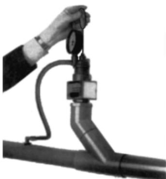
**Рисунок 2.17 – Регулировка рабочего вакуума**
