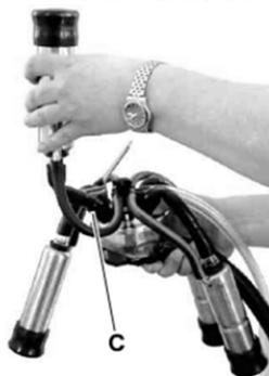
***Рисунок 2.27 – Надевание доильных стаканов***
