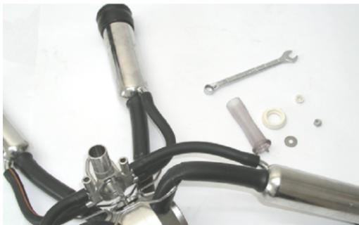
***Рисунок 6.19 – Проверка прокладки коллектора***
