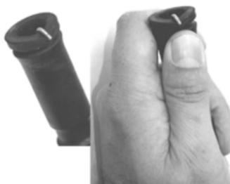
***Рисунок 6.23 – Зацепление крюка в сосковую резину***
