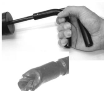
***Рисунок 6.24 – Стягивание сосковой резины***
