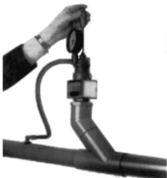
**Рисунок 2.17 – Регулировка рабочего вакуума**
