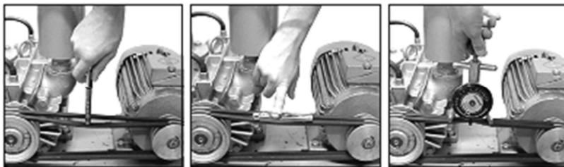
**Рисунок 1.38 – Проверка натяжения клинового ремня**
