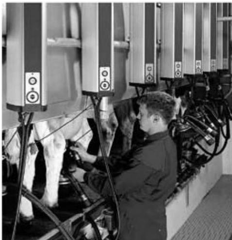
*Рисунок 2.10 – Устройство автоматического снятия подвесной части MP400*
