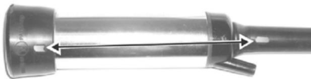
*Рисунок 6.3 – Метки на доильном стакане*
