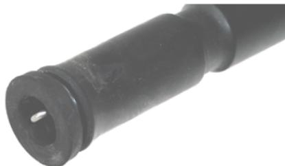
*Рисунок 6.13 – Установка крюка в сосковую резину*
