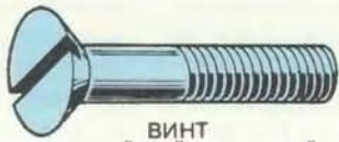
ВИНТ С ПОТАЙНОЙ ГОЛОВКОЙ
