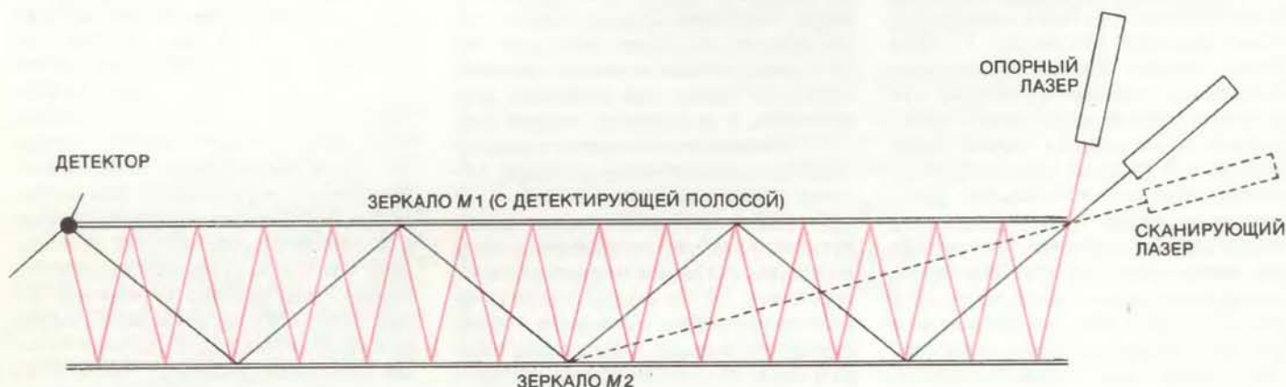
Лазерное аналоговое устройство показывает, что число 15 является не простым, а составным
