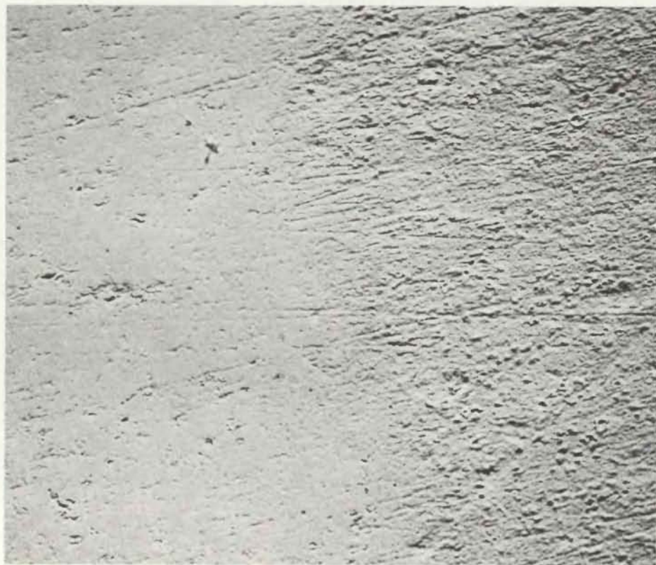
ПОВЕРХНОСТЬ ЛИСТА, покрытого золотом способом электрохимического осаждения в лаборатории Массачусетского технологического института и частично полированного. Лист был изготовлен из меди. Граница между полированной областью (слева) и неполированной (справа) видна в средней части фотографии (× 500).
