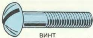
ВИНТ С ПОЛУКРУГЛОЙ ГОЛОВКОЙ
