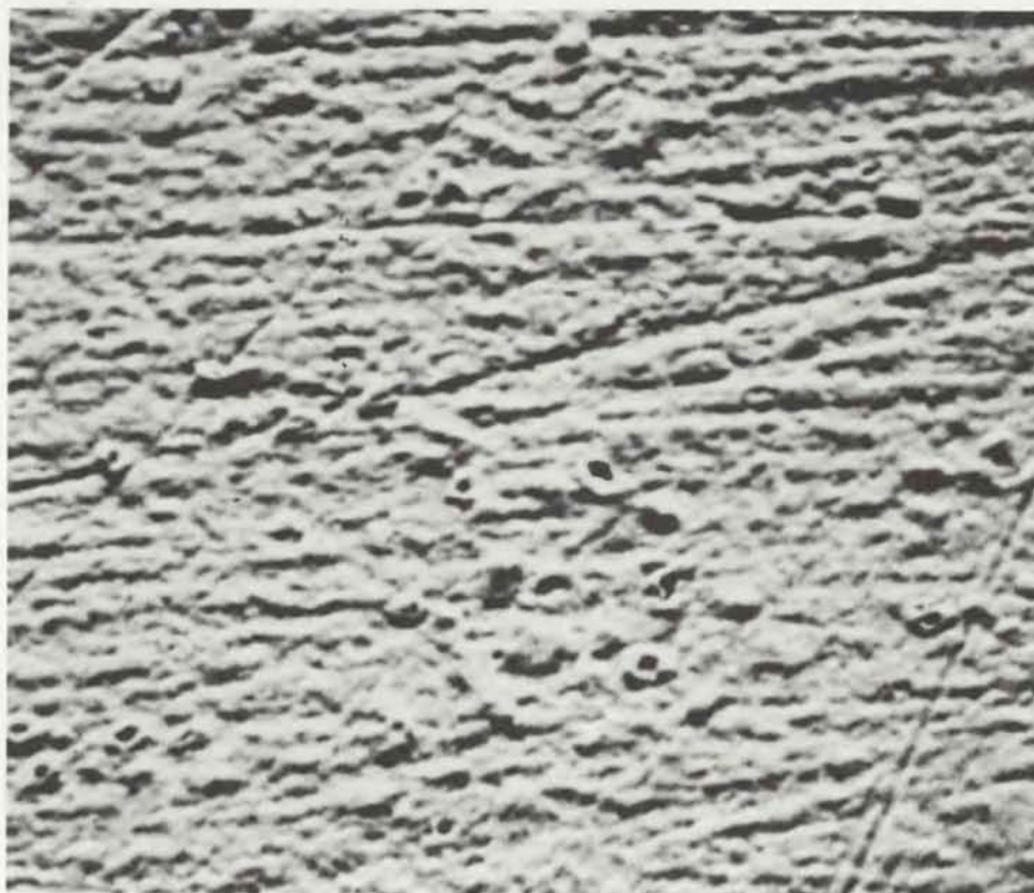
НЕПОЛИРОВАННАЯ ЧАСТЬ ЛИСТА покрыта кратеровидными порами (× 2000), образующимися при электрохимическом осаждении у анодных (положительно заряженных) ямок в меди. Для нанесения покрытия медный лист погружали в электролит с растворенным в нем золотом. Золото осаждается на поверхностях, прилегающих к анодным ямкам; эти поверхности являются катодными (отрицательно заряженными). В процессе осаждения вокруг каждой ямки образуется выступающее кольцо из золота.
