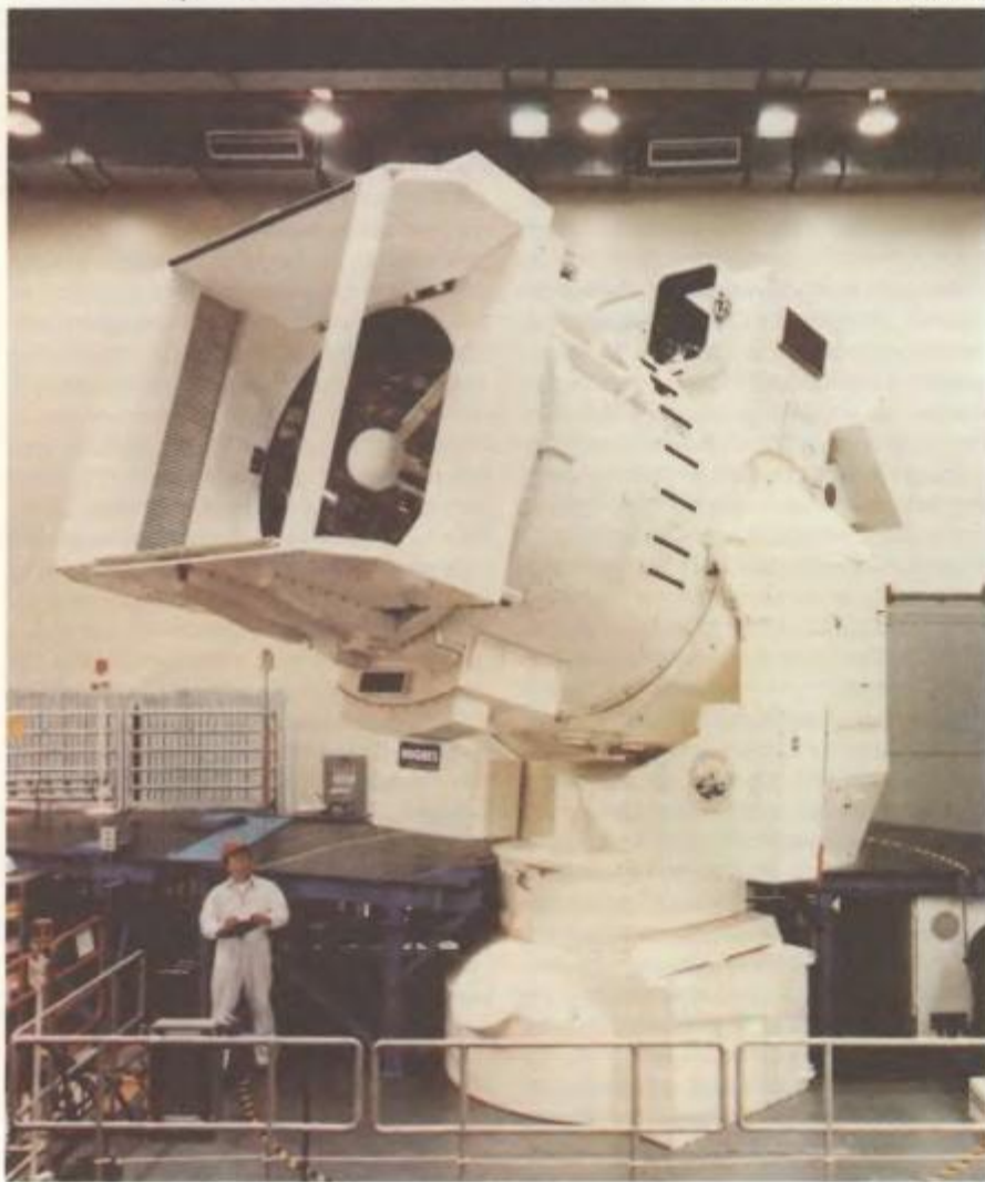
УСТРОЙСТВО УПРАВЛЕНИЯ лазерным лучом разработано компанией Hughes Aircraft в рамках исследований по программе СОИ. Оно предназначено для сопровождения объектов в полете и фокусировки мощного лазерного луча (генерируемого другим устройством) на выбранных целях. Хотя это устройство имеет военное назначение, разработанная для него технология, как утверждают сторонники СОИ, может найти применение и в гражданской промышленности.
