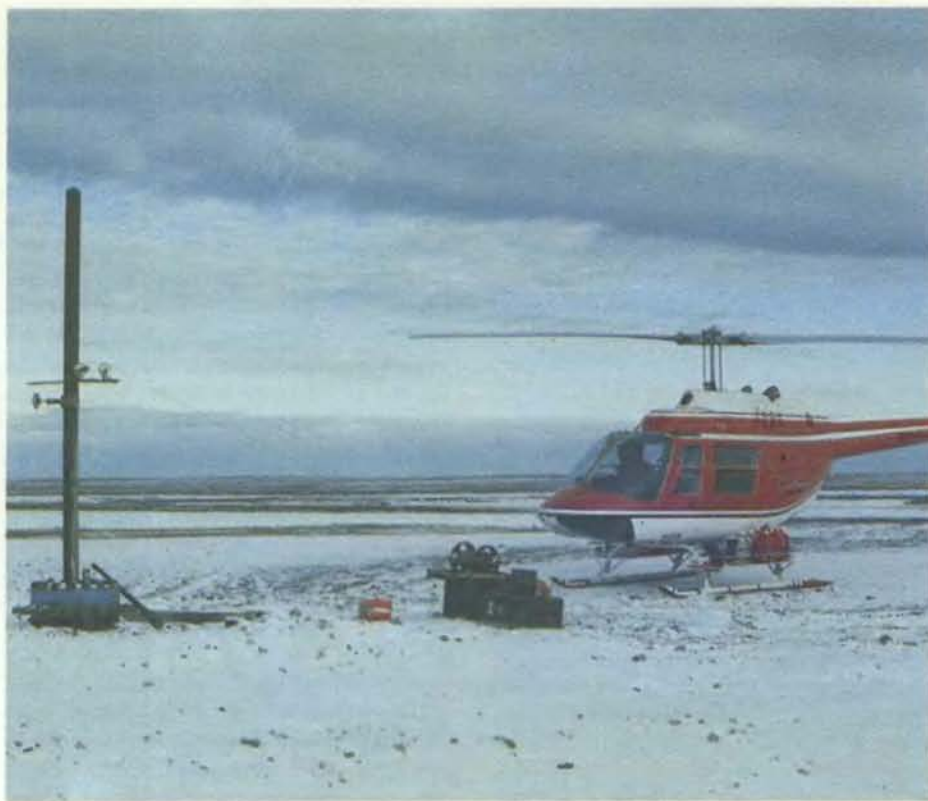
ЗАБРОШЕННАЯ НЕФТЯНАЯ СКВАЖИНА на северном склоне Аляскинского хребта, в которой можно проводить измерения температуры в многолетнемерзлом грунте. Геофизики заполняют скважины дизельным топливом и опускают в них датчики.
