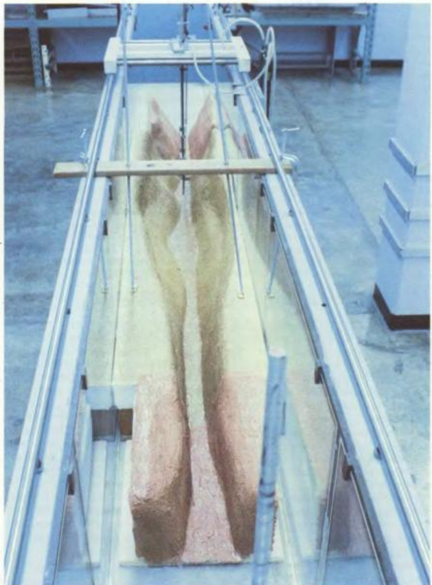
МОДЕЛЬ СЕГМЕНТА КАНАЛА была построена в лаборатории экспериментальных композиционных материалов корпорации FMC и установлена в гидравлической лаборатории Университета в Сан-Хосе. Смоделированный сегмент междолинного канала находился перед акведуком. Модель испытывалась в лаборатории в широком диапазоне чисел Фруда для установления того, зачем нужны были вариации поперечного сечения. Некоторые результаты испытаний приведены на следующем рисунке.
