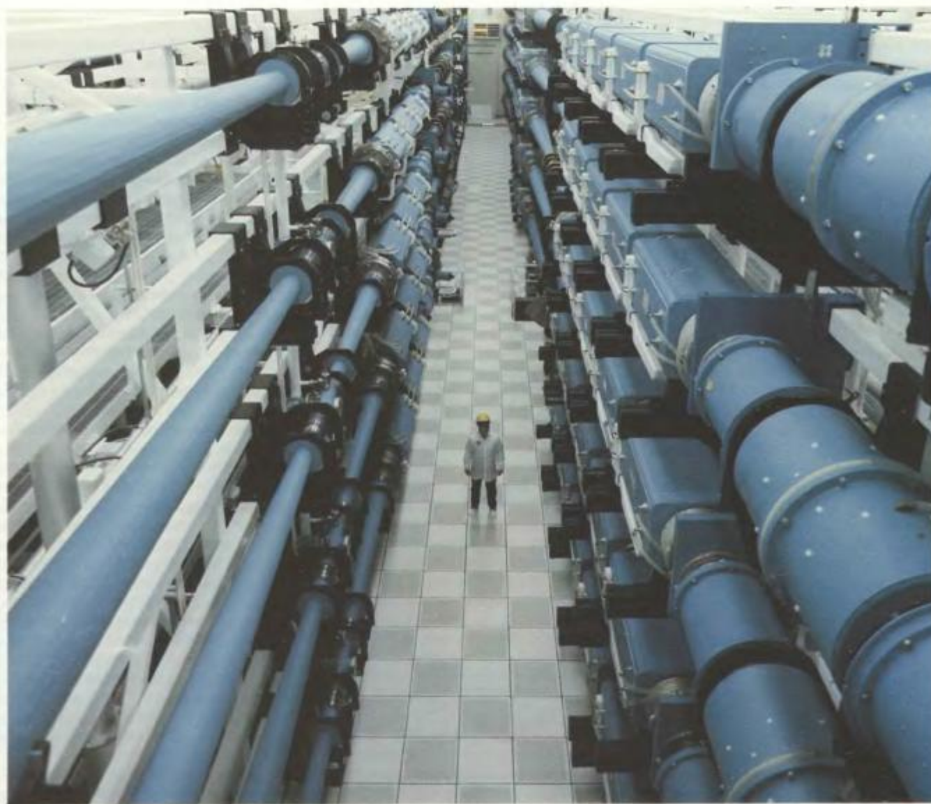
ЛАЗЕР «НОВА», построенный в Ливерморской национальной лаборатории им. Лоуренса, является самым мощным в мире оптическим лазером. Он может генерировать энергию 100 000 Дж менее чем за одну миллиардную долю секунды, т. е. импульс мощностью 10^{14} Вт. Два из 10 пучков
