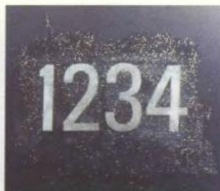
СИСТЕМА «ЯРЛЫКОВ» была разработана Национальными лабораториями в Сандии. Идентификационный номер на корпусе ракеты покрыт эпоксидной смолой, которая содержит частицы слюды, отражающие свет. При освещении под различными углами (ср. изображения слева и справа) частицы слюды образуют «уникальный рисунок».
