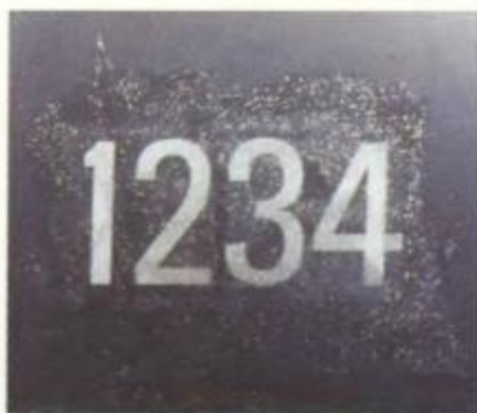
СИСТЕМА «ЯРЛЫКОВ» была разработана Национальными лабораториями в Сандии. Идентификационный номер на корпусе ракеты покрыт эпоксидной смолой, которая содержит частицы слюды, отражающие свет. При освещении под различными углами (ср. изображения слева и справа) частицы слюды образуют «уникальный рисунок».
