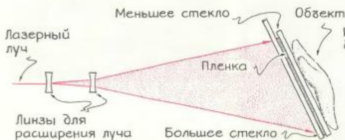
Схема изготовления голограмм по методу Денисюка
