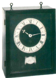
Механические часы с пружинным приводом, созданные датским мастером Соломоном Костером в 1657 г. Костер сотрудничал с Христианом Пойгенсом, который первым использовал маятник в конструкции механических часов.
