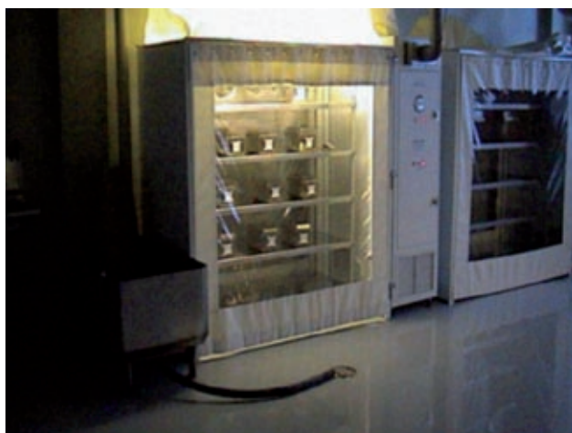
Рис 2. Чистые комнаты Duo Flo (Lab Products) для содержания инфицированных лабораторных животных при нормальной концентрации кислорода во вдыхаемом воздухе.
