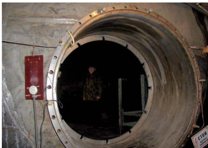
В камере ВБК-2 исследуется нестационарное горение в кумулирующих устройствах. Объем 110 м 3 , рассчитана на взрыв 20 кг ТНТ.
