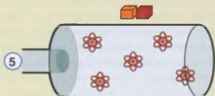
При выключенных лазерах атомы медленно распространяются по всему объему магнитной ловушки. Газ, расширяясь, остывает
