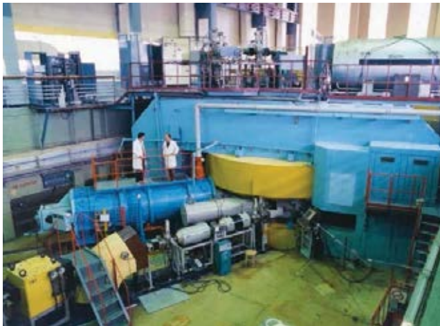
Ускоритель тяжелых ионов Лаборатории ядерных реакций ОИЯИ, на котором впервые были получены интенсивные пучки ионов кальция-48
